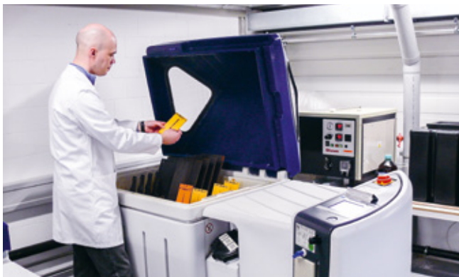
Salt spray test to DIN EN ISO 9227
